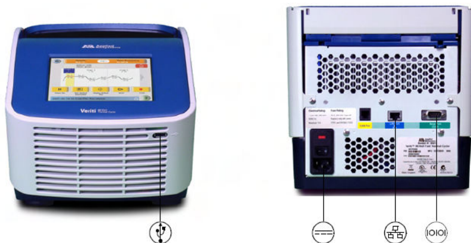
Obrázek A-1 Přívodní kabel a připojení cykleru Veriti™
